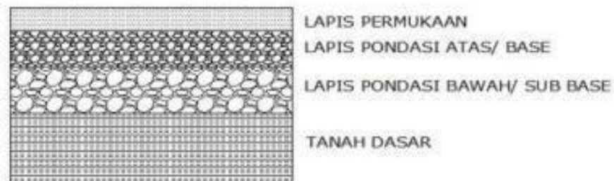
Gambar 3.1 Susunan Lapis Perkerasan Lentur Sumber : Bina Marga No. 03/MN/B/1983)
