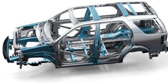
**Gambar 2.3** Rangka Jenis *Monocoque*
