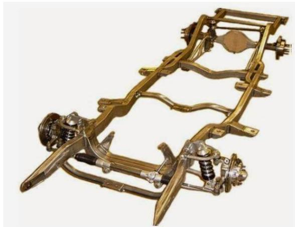
**Gambar 2.2** Rangka Jenis *Ladder Frame*
