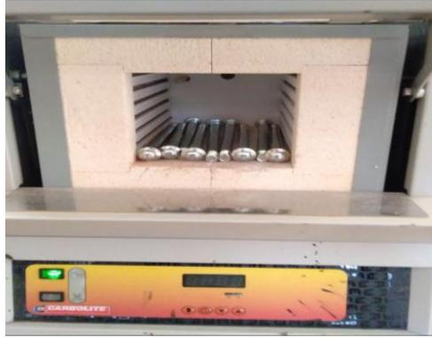
Gambar 3.4. Spesimen dimasukkan dalam oven pemanas
