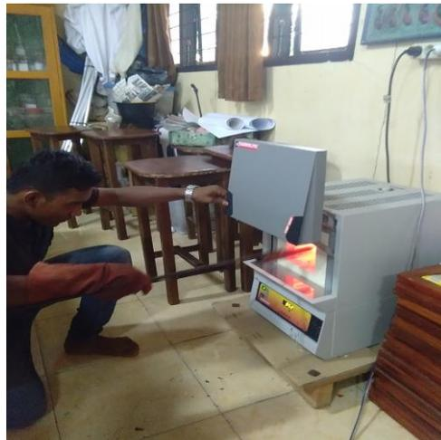
Gambar 3.6. Spesimen dikeluarkan dari oven pemanas
