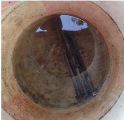
Gambar 3.7. Spesiman didalam larutan garam
