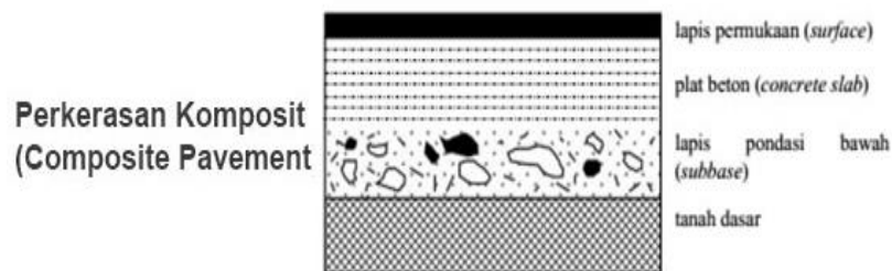
Gambar 3. 4 Susunan Lapisan Perkerasan Komposit
