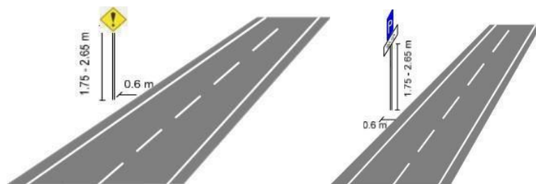
Gambar3.21 Penempatan ketinggian rambu di sisi jalan
