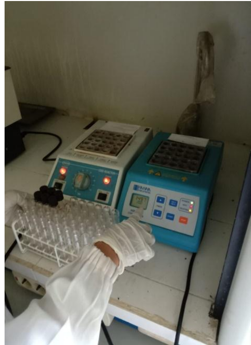
Tabung diletakkan pada COD reaktor yg telah dipanaskan pada suhu 150°C. setting selama 2 jam
