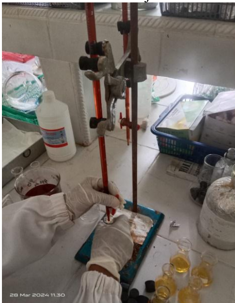
Kemudian di titrasi dgn larutan Fas sampai warna merah
