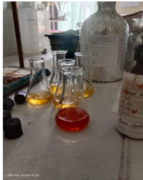
Hasil akhir titrasi. sampel diawetkan dgn menambahkan H 2 SO 4 pekat sampai pH kecil dari 2
