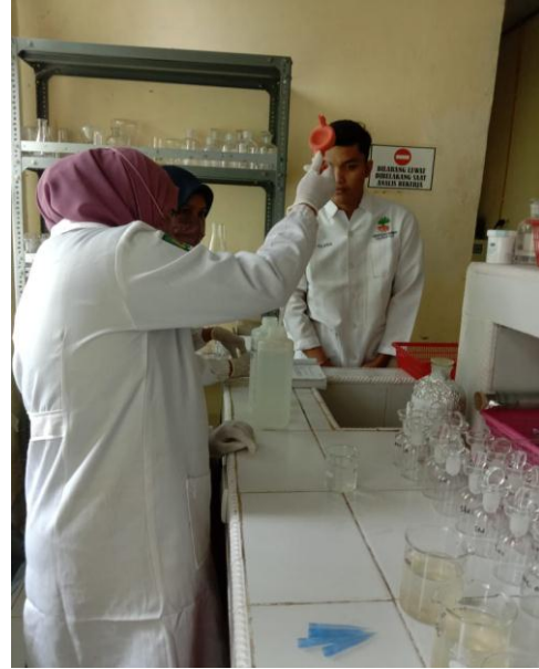
Penambahan polyseed kedalam aquades yg telah diaerasi
