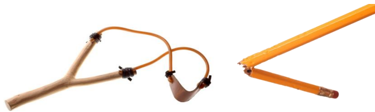
Gambar 2.15 (a) Tali ketapel memiliki sifat yang elastis karena ketika diberikan gaya, akan kembali ke bentuk semula. Sementara itu, (b) pensil yang terbuat dari kayu bersifat plastis, karena ketika diberikan gaya, tidak kembali ke bentuk semula
