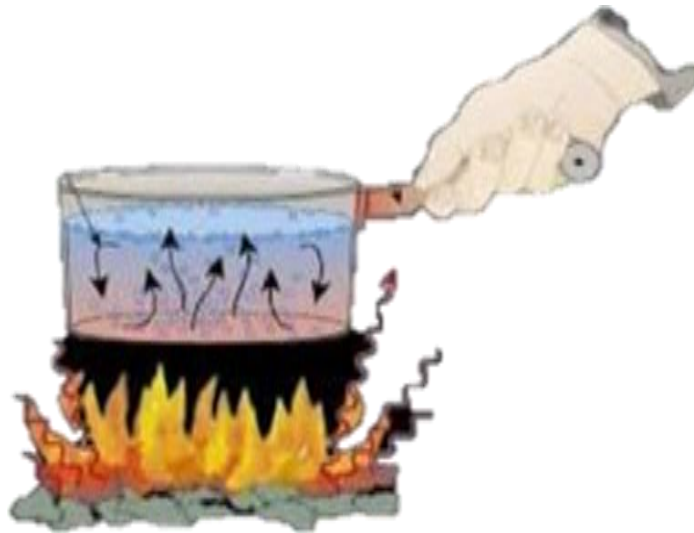
Gambar 2.2 Peristiwa Perpindahan Kalor Secara Konveksi
