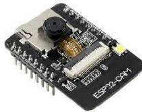
**Gambar 2. 4 Module ESP32Cam**
