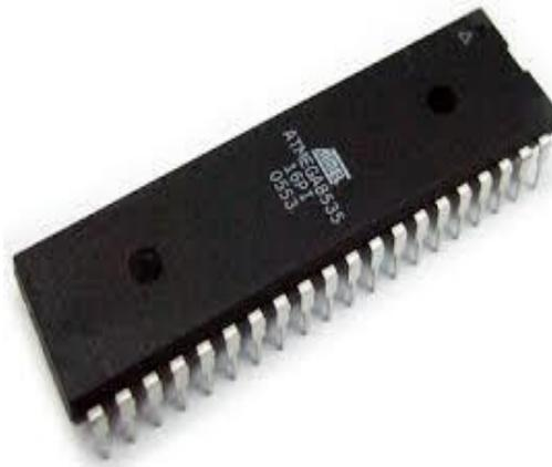
**Gambar 2.1** Mikrokontroler ATmega 8535
