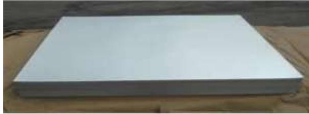
Gambar 3.8 Aluminium plat tebal 3 mm
