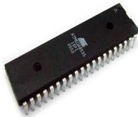
Gambar 2.2 Mikrokontroler *ATmega 8535*
