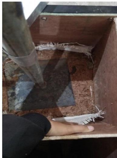
Gambar 4.6 Bentuk Tapak Fondasi diatas Permukaan
