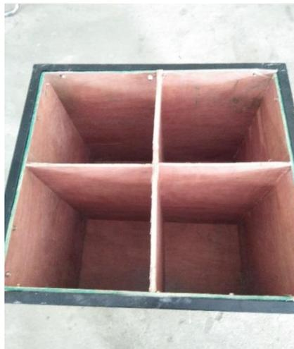
Gambar 4.2 Bentuk Sekat Bak Pengujian
