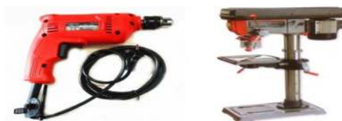
Gambar 2.33. Mesin bor, a) Bor tangan, b) Bor tegak
