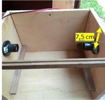
Gambar 3.6 Pemasangan Fitting Lampu
