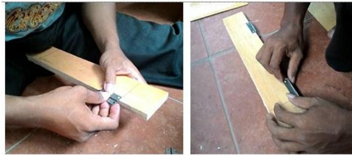
Gambar 3.10 Pemasangan Engsel
