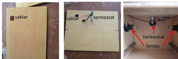
Gambar 3.8 Pemasangan Thermostat
